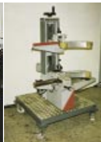
Кругло-загибочный станок. Закругленная предварительно фальцованная металлическая полоса.
