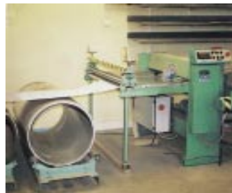
Поточная линия обрезки с делительными блоками.
