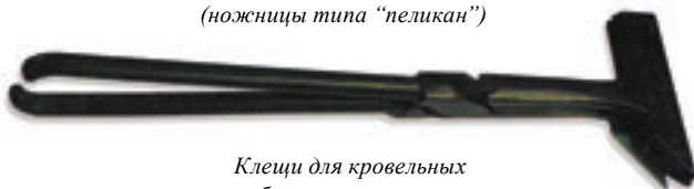
Ножницы для кровельных работ (ножницы типа "пеликан")
