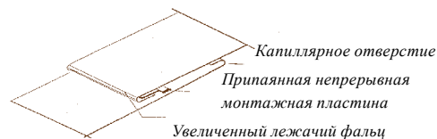
Пример припаянной непрерывной монтажной пластины.
